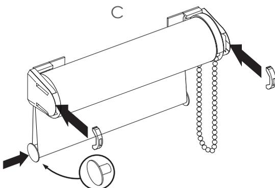
C: Befestigen Sie erneut die Metallleiste an den Befestigungsträgern und hängen das Rollo wieder ein. Nun werden die Verschlusskappen aufgesteckt. Des Weiteren bringen Sie die Abdeckkappen am Beschwerungsstab ein und führen ihn durch die Stofftasche.
