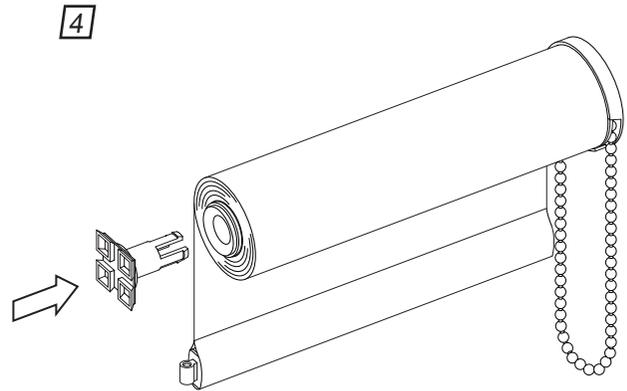
Stecken Sie den Montageadapter auf das Bedienprofil auf.
