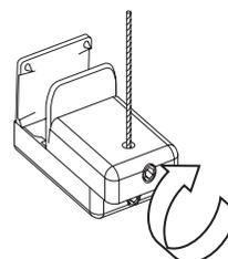
Spannen Sie die Spanndrähte und arretieren Sie sie mit der Stellschraube.
