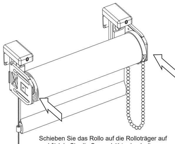
Schieben Sie das Rollo auf die Rolloträger auf und fädeln Sie die Spanndrähte durch die Spanndrahtgleiter.
