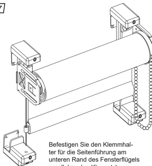
Befestigen Sie den Klemmhalter für die Seitenführung am unteren Rand des Fensterflügels parallel zu den Klemmträgern des Rollos. Fixieren Sie sie mithilfe der Stellschrauben.
