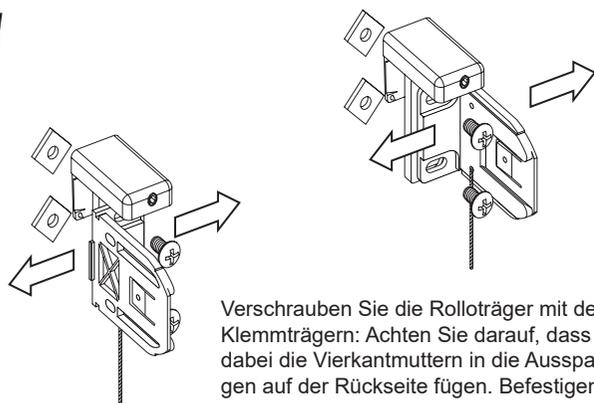
Verschrauben Sie die Rolloträger mit den Klemmträgern: Achten Sie darauf, dass sich dabei die Vierkantmuttern in die Aussparungen auf der Rückseite fügen. Befestigen Sie die Träger dann an der gewünschten Position am Fenster. Fixieren Sie sie mit den Stellschrauben.
