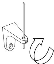
Führen Sie die Spanndrähte durch die Wandwinkel, straffen Sie sie und fixieren Sie sie mithilfe der Stellschrauben.
