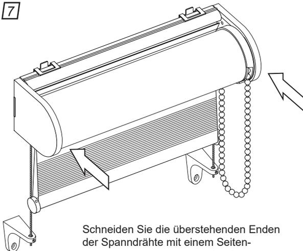
Schneiden Sie die überstehenden Enden der Spanndrähte mit einem Seitenschneider oder einer scharfen Schere ab.
