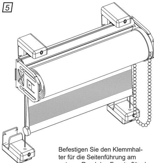
Befestigen Sie den Klemmhalter für die Seitenführung am unteren Rand des Fensterflügels parallel zu den Klemmträgern des Rollos. Fixieren Sie sie mithilfe der Stellschrauben.
