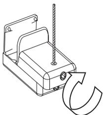
Spannen Sie die Spanndrähte und arretieren Sie sie mit der Stellschraube.
