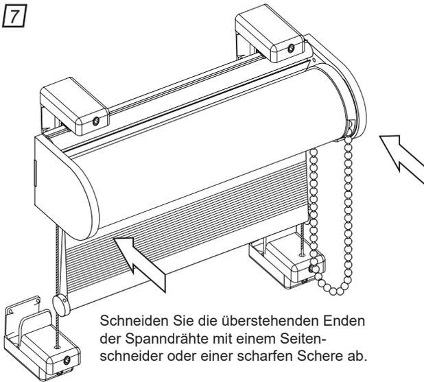
Schneiden Sie die überstehenden Enden der Spanndrähte mit einem Seitenschneider oder einer scharfen Schere ab.
