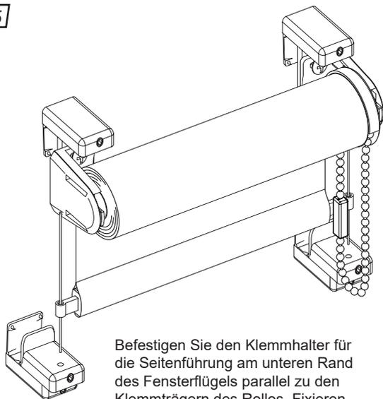
Befestigen Sie den Klemhalter für die Seitenführung am unteren Rand des Fensterflügels parallel zu den Klemmträgern des Rollos. Fixieren Sie sie mithilfe der Stellschrauben.
