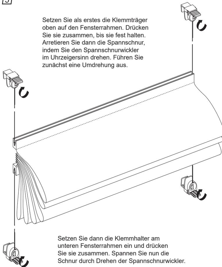
Setzen Sie als erstes die Klemmträger oben auf den Fensterrahmen. Drücken Sie sie zusammen, bis sie fest halten. Arretieren Sie dann die Spannschnur, indem Sie den Spannschnurwickler im Uhrzeigersinn drehen. Führen Sie zunächst eine Umdrehung aus.
