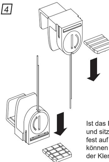
Ist das Raffrollo verspannt und sitzen die Klemmträger fest auf dem Fensterrahmen, können Sie die Überstände der Klemmwinkel abbrechen.
