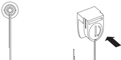
Legen Sie die Spannschnüre in einer Schlaufe um den Spannschnurwickler und setzen Sie diesen in den Spannhalter ein. Der Schnurüberstand sollte dabei zwischen 10 und 15 cm betragen. Wiederholen Sie den Schritt an allen vier Spannschnurenden.
