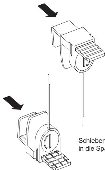
Schieben Sie die Klemmwinkel in die Spannhalter.
