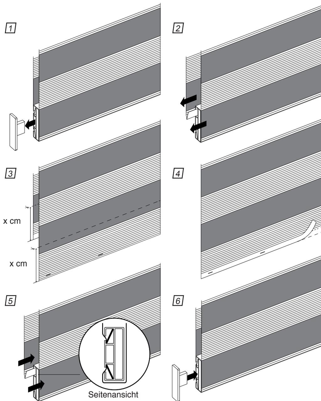
Entfernen Sie die seitlichen Abdeckkappen und ziehen Sie beide Stoffbahnen aus der Beschwerungsschiene heraus
