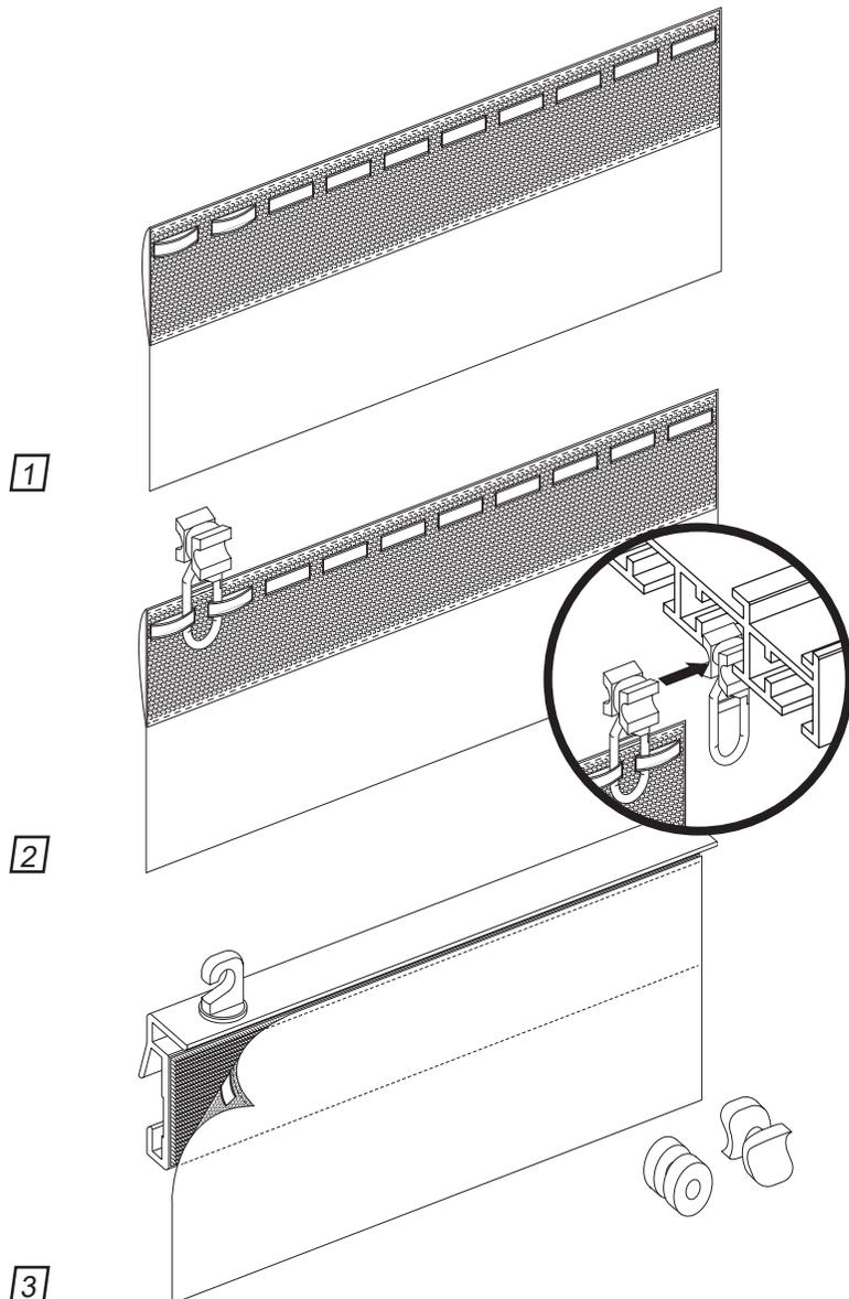
Schiebevorhang mit vormontierter Schiene
